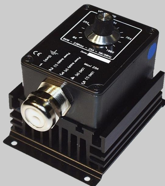
Unité autonome et compacte permettant une commande de puissance proportionnelle des charges résistives par salves variables d'ondes entières (charge à forte inertie) ou par variation d'angle de phase (charge à faible inertie) , Peut être utilisé avec la plupart des résistances chauffantes.
